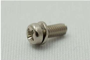
座金付きネジ(セムスネジ)は、座金内径より、ネジ山の高さの方が高いため、ネジを取り外しても、座金がネジから離れない製品です。
